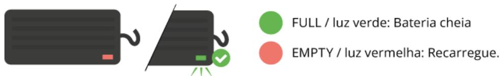
Conecte a tomada de 3 pinos no patinete e em seguida, conecte o plugue AC na rede elétrica. O carregador tem uma luz vermelha que indica que está carregando. Assim que a luz do carregador ficar verde, a bateria está carregada.
