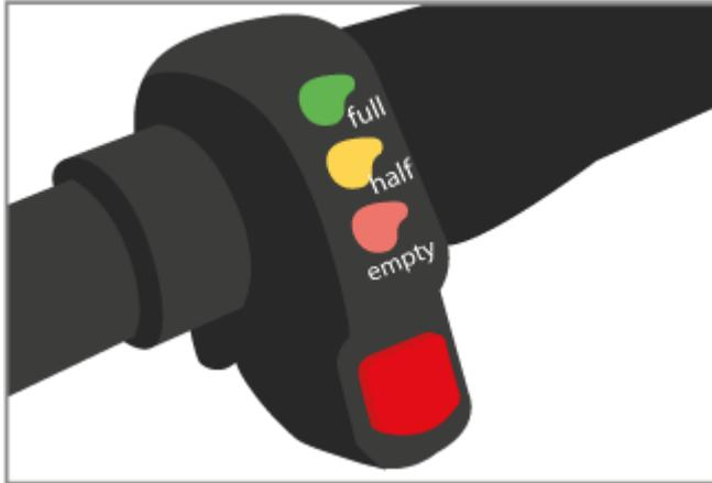
O patinete oferece o recurso do modo econômico. A função dele é limitar a velocidade em 50% e com isso promover uma economia de energia. Para acionar, basta apertar o botão vermelho embaixo do medidor de nível da bateria, próximo ao acelerador.
